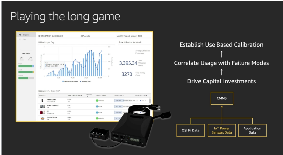
〈그림 4〉 모더나의 실험실 장비 IoT 모니터링 장치 구축 및 예측 유지 보수 메커니즘
